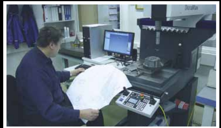
Tarkastaja Jorma Luukkanen mittaa suunnittelun piirtämää prototyyppimoottorin osaa.
