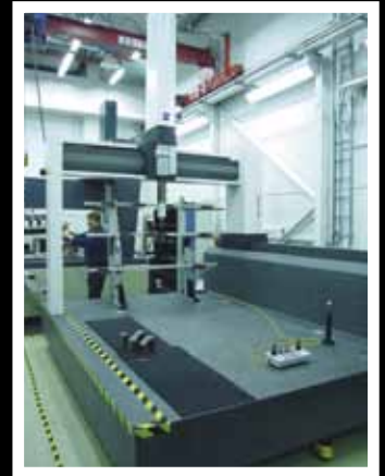
Etuallalla uusi isompi mittauskone, taustalla vanhan Mauser -koordinaattimittauskoneen tekemä sylinteriryhmän mittaus on juuri saatu päätökseen.
